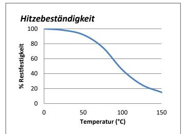
"Hitzebeständige" Scherfestigkeitsversuche wurden auf Glas auf Weichstahl Klebeverbindungen durchgeführt. Vor den Testversuchen wurden die Teile über 30 Minuten auf der Testtemperatur gehalten.
