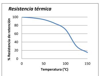
Resistencia térmica. pruebas de resistencia realizadas en acero y vidrio. Ejemplares completamente curados y condicionados a temperatura durante 30 minutos antes de la prueba a temperatura.
