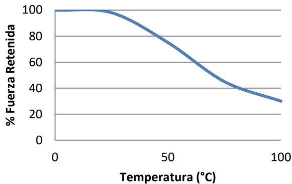
Muestras de cizallamiento completamente curadas acondicionadas para tirar de la temperatura durante 30 minutos antes de la prueba a temperatura. TA4631 puede soportar temperaturas más altas durante períodos breves (como para los procesos de horneado de pintura y soldadura por onda) proporcionando la articulación no está excesivamente estresado. La temperatura mínima a la que se puede exponer el adhesivo curado es -55°C dependiendo de los materiales que se van a unir.
