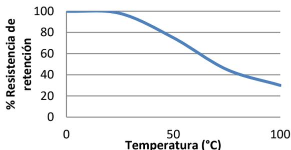
“Resistencia térmica” pruebas de resistencia realizadas en acero. Ejemplares completamente curados y condicionados a la temperatura de prueba durante 30 minutos antes de la prueba.
