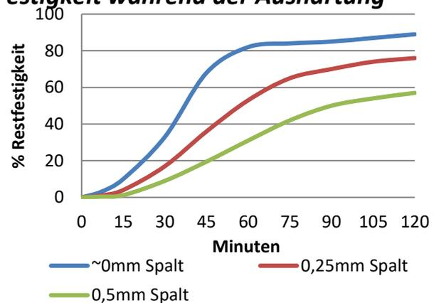
Das Diagramm zeigt den typischen Aufbau der Festigkeit bei der Verklebung von Probestücken bei 23°C. Aushärtung bei höheren oder niedrigeren Temperaturen beeinflusst die Aushärtungsgeschwindigkeit.
