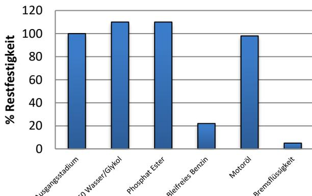
Probestücke wurden 30 Tage lang bei 85°C in den verschiedenen Testflüssigkeiten gehalten und bei Raumtemperatur getestet.
