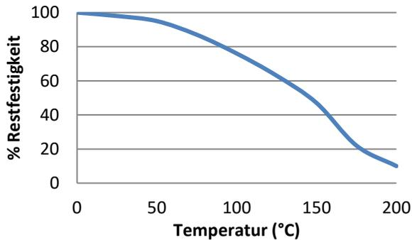
„Hitzebeständige“ Scherfestigkeitsversuche wurden auf Weichstahl durchgeführt. Aushärtung bei Raumtemperatur vollständig. Vor den Testversuchen wurden die Teile über 30 Minuten auf der Testtemperatur gehalten.
