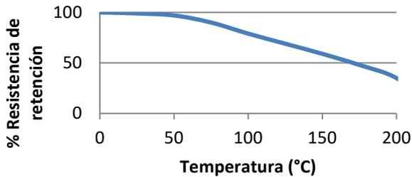
Resistencia térmica pruebas de resistencia realizadas en acero. Curado de 24 horas a temperatura ambiente y condicionado a la temperatura de prueba durante 30 minutos.
