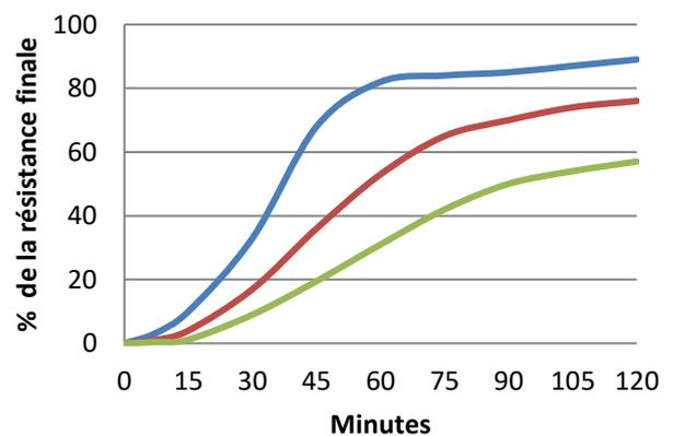
Le graphique ci-dessus montre l'évolution typique de la résistance pour des pièces collées à une température de 23°C. Une température plus élevée ou plus basse risque de changer la vitesse de polymérisation.
