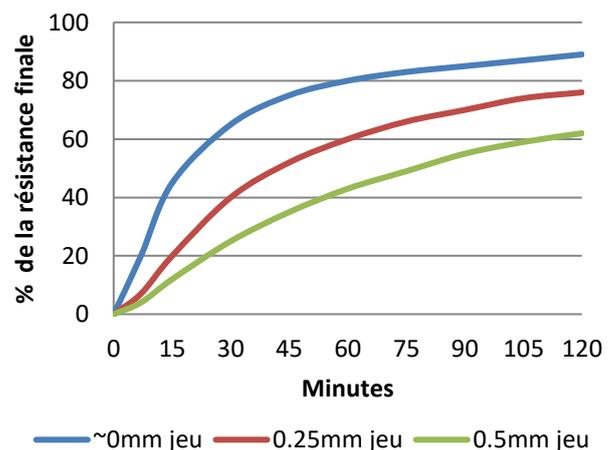
Le graphique ci-dessus montre l'évolution typique de la résistance pour des pièces collées à une température de 23°C. Une température plus élevée ou plus basse risque de changer la vitesse de polymérisation.
