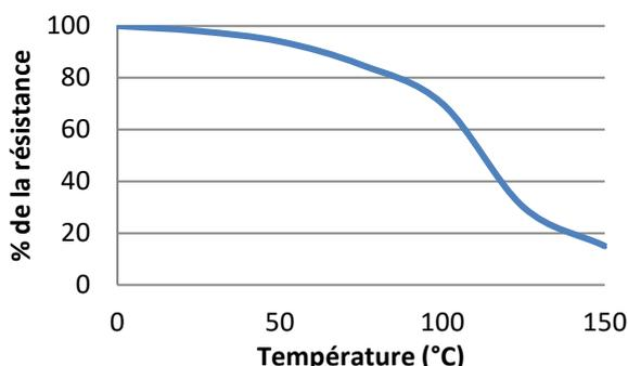
Essais de résistance au cisaillement à des températures élevées sur acier doux. Polymérisation complète à température ambiante, puis mise en température durant 30 minutes avant réalisation des essais.
