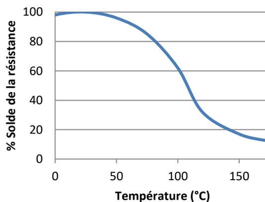
Essais de cisaillement en température réalisés sur l'acier doux. Polymérisation complète à température ambiante, puis mise en température durant 30 minutes avant réalisation des essais.
