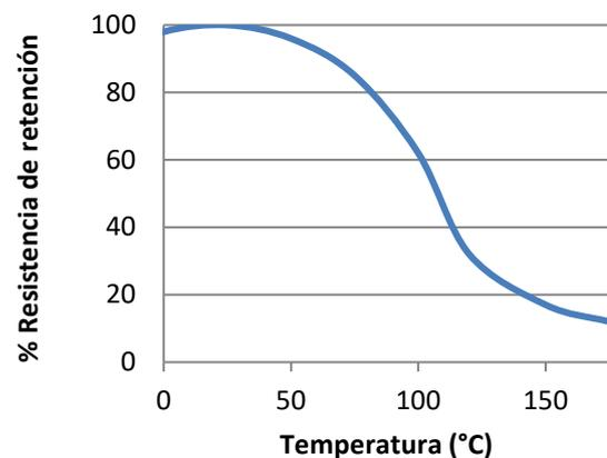
**"Resistencia térmica." pruebas de resistencia realizadas en acero. Ejemplares completamente curados y condicionados a temperatura durante 30 minutos antes de la prueba a temperatura.**
