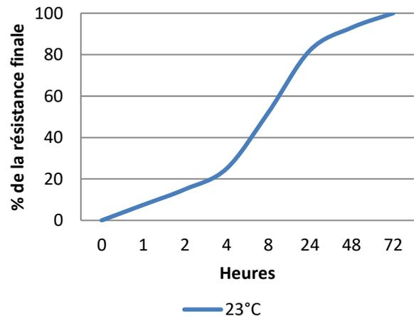
Le graphique ci-dessus montre l'évolution typique de la résistance pour des pièces collées à une température de 23°C. Une température plus élevée ou plus basse risque de changer la vitesse de polymérisation.
