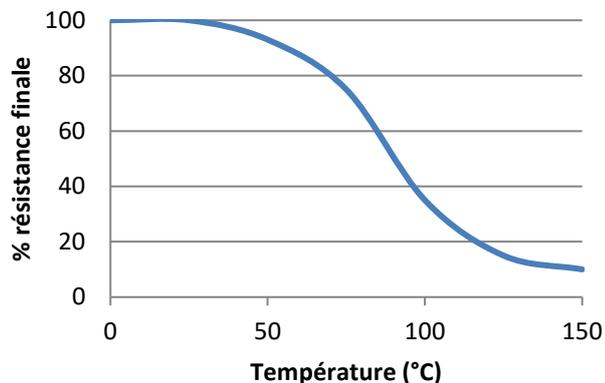
Tests de résistance au cisaillement à des températures élevées sur acier doux. Polymérisation complète à température ambiante, puis mise en température durant 30 minutes avant réalisation des essais.
