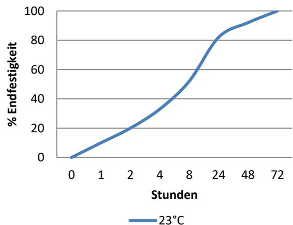
Das Diagramm zeigt den typischen Aufbau der Festigkeit bei der Verklebung von Probestücken bei 23°C. Aushärtung bei höheren oder niedrigeren Temperaturen beeinflusst die Aushärtungsgeschwindigkeit.
