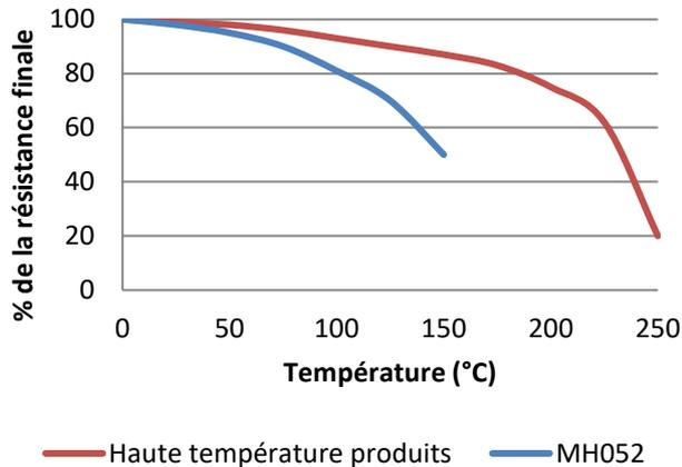
"Dureté à chaud" l'évolution du couple de rupture en fonction du temps sur des boulons M10 en acier zingué selon la norme ISO 10964. Polymérisation de 24 heures à 23°C. Puis conditionnement de 30 minutes à des températures montrées dans le graphique.
