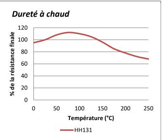
"Dureté à chaud" Couple de rupture sur des boulons M10 en acier zingué selon la norme ISO 10964. Polymérisé à 23° pendant 24 heures puis conditionné pendant 30 minutes à des températures d'essai.
