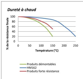
"Dureté à chaud" Couple de rupture sur des boulons M10 en acier zingué selon la norme ISO 10964. Polymérisé à 23° pendant 24 heures puis conditionné pendant 30 minutes à des températures d'essai.
