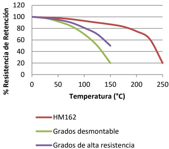
*"Resistencia Térmica" Resistencia a rotura en tuercas y tornillos zincados de M10 según la norma ISO 10964. Curado a 23 °C durante 24 horas y después acondicionado durante 30 minutos a temperatura de prueba.*
