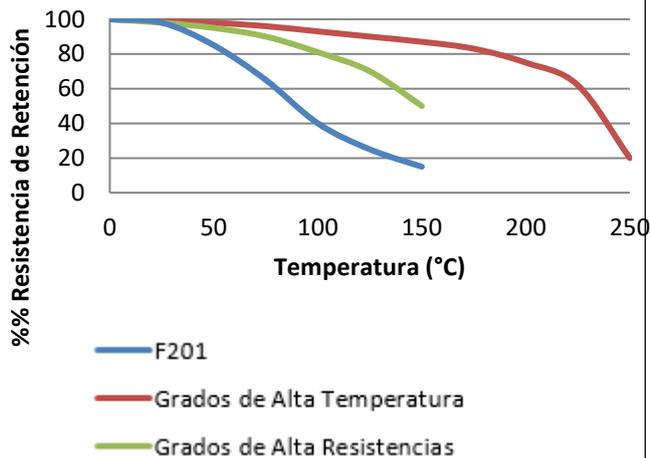
*"Resistencia Térmica" Resistencia a rotura en tuercas y tornillos zincados de M10 según la norma ISO 10964. Curado a 23 °C durante 24 horas y después acondicionado durante 30 minutos a temperatura de prueba.*
