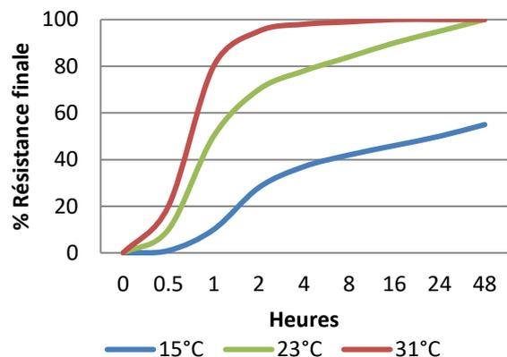
Ce graphique montre un développement typique de la résistance des composants collés. Une augmentation de température de 8° réduira de moitié le temps de polymérisation. Plus les températures sont basses, plus le temps de polymérisation est long.
