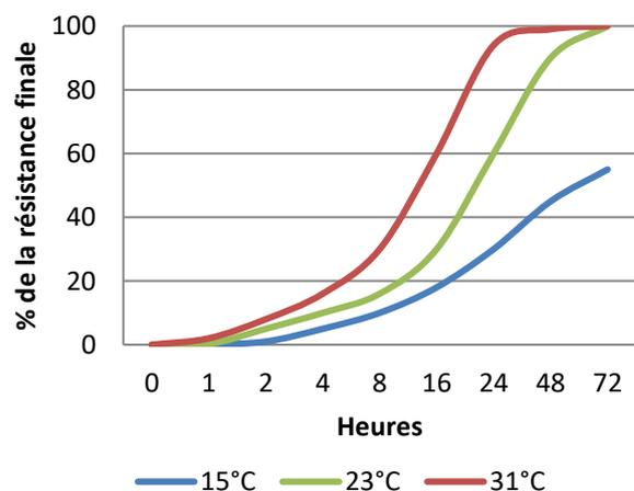
Ce graphique montre un développement typique de la résistance des composants collés. Une augmentation de la température de 8° réduira de moitié le temps de polymérisation. Plus les températures sont basses, plus le temps de prise est long.
