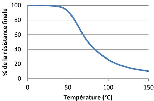
Essais de cisaillement en température réalisés sur l'acier doux. Les échantillons sont entièrement polymérisés avant d'être mis en température pendant 30 minutes avant réalisation des essais.
