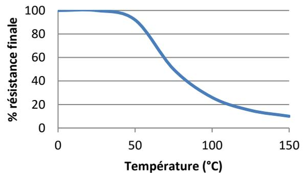
Tests de résistance au cisaillement à des températures élevées sur acier doux. Polymérisation complète à température ambiante, puis mise en température durant 30 minutes avant réalisation des essais.
