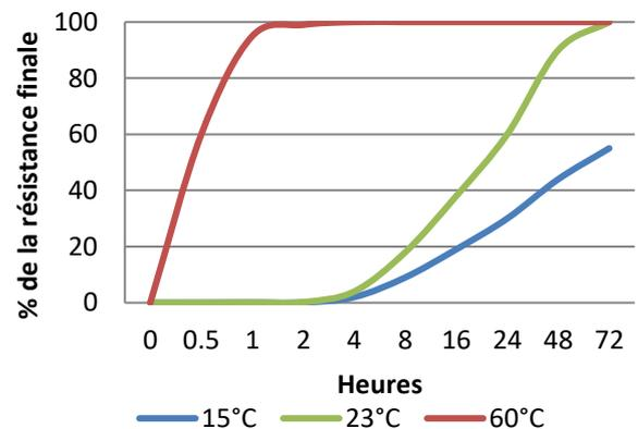
Ce graphique montre un développement typique de la résistance des composants collés. Une augmentation de température de 8° réduira de moitié le temps de polymérisation. Plus les températures sont basses, plus le durcissement est lent.
