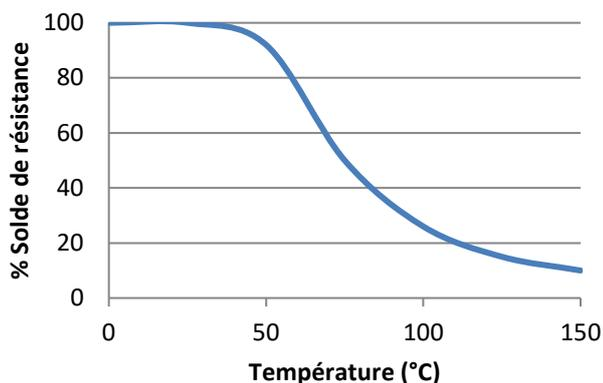
Essais de cisaillement en température réalisés sur l'acier doux. Les échantillons sont entièrement polymérisés avant d'être mis en température pendant 30 minutes avant réalisation des essais.
