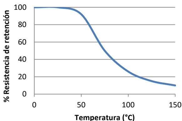
"Resistencia térmica" Pruebas de resistencia realizadas en acero. Ejemplares completamente curados y condicionados a la temperatura de prueba durante 30 minutos antes de la prueba.
