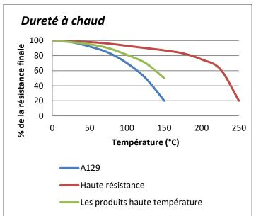
"Dureté à chaud" l'évolution du couple de rupture en fonction du temps sur des boulons M10 en acier zinqué selon la norme ISO 10964. Polymérisation de 24 heures à 23°C. Puis conditionnement de 30 minutes à des températures montrées dans le graphique.
