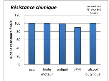
Ce produit n'est pas recommandé pour une utilisation en contact avec de la vapeur d'eau, des substances fortement oxydantes ou des solvants polaires, bien qu'il puisse résister à des nettoyages au solvant sans détérioration de ses propriétés adhésives.
