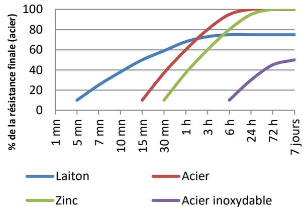
Ces données sont typiques pour des surfaces acier à 23°C. Le cuivre et les alliages cuivreux donnent une polymérisation plus rapide. Les surfaces oxydées ou passivées ainsi que le zinc donnent une polymérisation plus lente. Une température basse ou un jeu important ralentiront aussi la polymérisation. Pour réduire le temps de polymérisation nous préconisons l'utilisation de notre activateur Permabond A905 ou de chauffer l'assemblage dans la mesure du possible.
