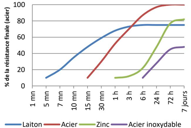
Ces données de polymérisation sont typiques à 23°C. Le cuivre et ses alliages accélèrent la polymérisation tandis que les surfaces oxydées ou passivées, tel l'acier inoxydable, la ralentissent. Une température basse ou un jeu important ralentiront aussi la polymérisation. Pour réduire le temps de polymérisation nous préconisons l'utilisation de notre activateur Permabond A905 ou de chauffer l'assemblage dans la mesure du possible.
