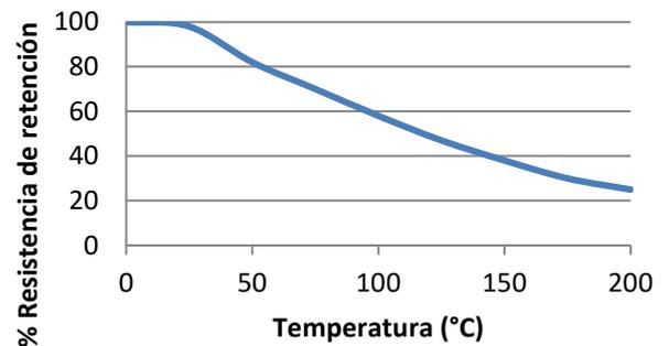
"Resistencia térmica" pruebas de resistencia realizadas en acero. Ejemplares completamente curados y condicionados a temperatura durante 30 minutos antes de la prueba a temperatura."
