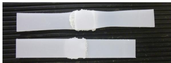
Prueba de resistencia al corte con láminas de polipropileno sin tratamiento superficial, adheridas con TA4610. La unión adhesiva es tan fuerte que el plástico se estira, se deforma y falla antes de la unión.
