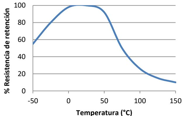
Resistencia térmica. pruebas de resistencia realizadas en acero. Curado de 24 horas a temperatura ambiental y condicionado a la temperatura de prueba durante 30 minutos.
