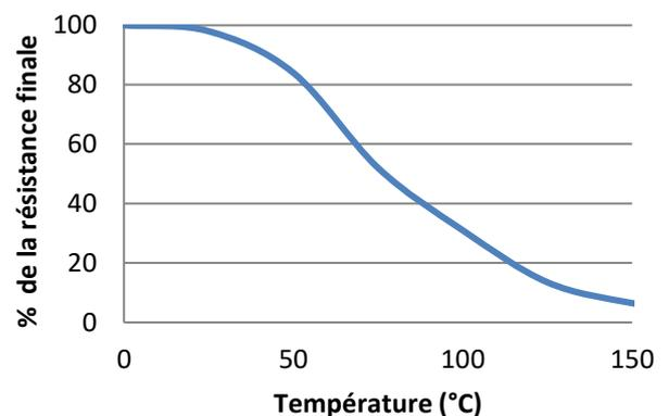
"Essais de "dureté à chaud" sur acier. Polymérisation complète à température ambiante, puis mise en température pendant 30 minutes avant réalisation des essais.
