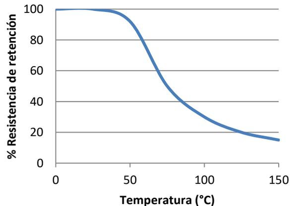
Resistencia térmica pruebas de resistencia realizadas en acero. Curado de 24 horas a temperatura ambiental y condicionado a la temperatura de prueba durante 30 minutos.
