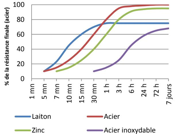
Ces données sont typiques pour des surfaces acier à 23°C. Le cuivre et les alliages cuivreux donnent une polymérisation plus rapide. Les surfaces oxydées ou passivées ainsi que le zinc donnent une polymérisation plus lente. Une température basse ou un jeu important ralentiront aussi la polymérisation. Pour réduire le temps de polymérisation nous préconisons l'utilisation de notre activateur Permabond A905 ou de chauffer l'assemblage dans la mesure du possible.
