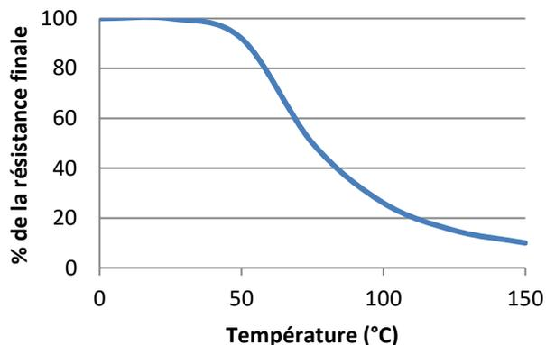
Essais de résistance au cisaillement à des températures élevées sur acier doux. Polymérisation complète à température ambiante, puis mise en température durant 30 minutes avant réalisation des essais.
