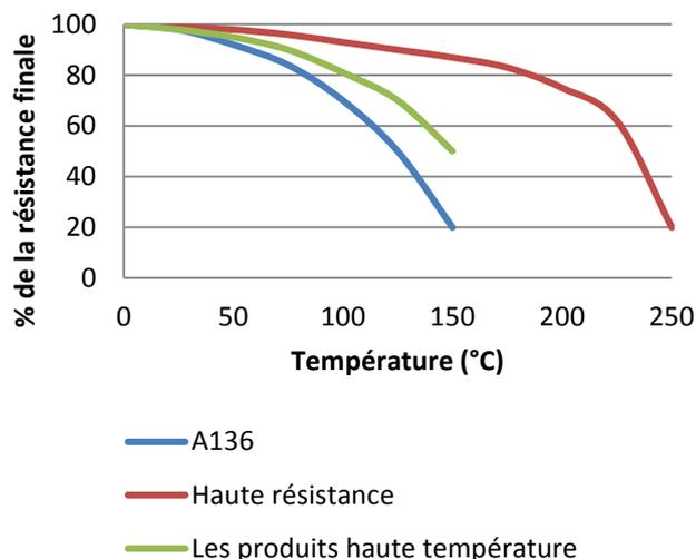
“Dureté à chaud” l'évolution du couple de rupture en fonction du temps sur des boulons M10 en acier zingué selon la norme ISO 10964. Polymérisation de 24 heures à 23°C. Puis conditionnement de 30 minutes à des températures montrées dans le graphique.
