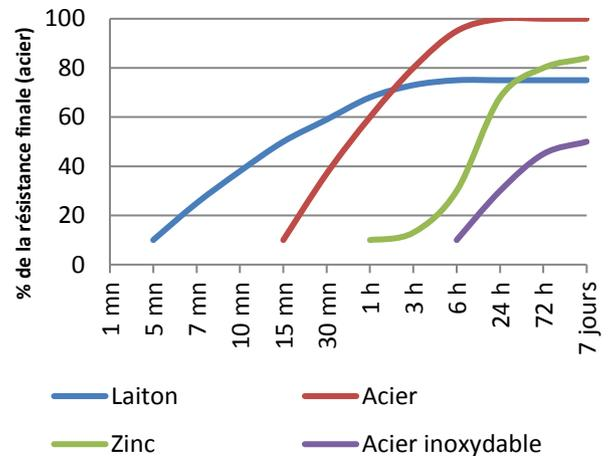
Ces données de polymérisation sont typiques à 23°C. Le cuivre et ses alliages accélèrent la polymérisation tandis que les surfaces oxydées ou passivées, tel l'acier inoxydable, la ralentissent. Une température basse ou un jeu important ralentiront aussi la polymérisation. Pour réduire le temps de polymérisation nous préconisons l'utilisation de notre activateur Permabond A905 ou de chauffer l'assemblage dans la mesure du possible.
