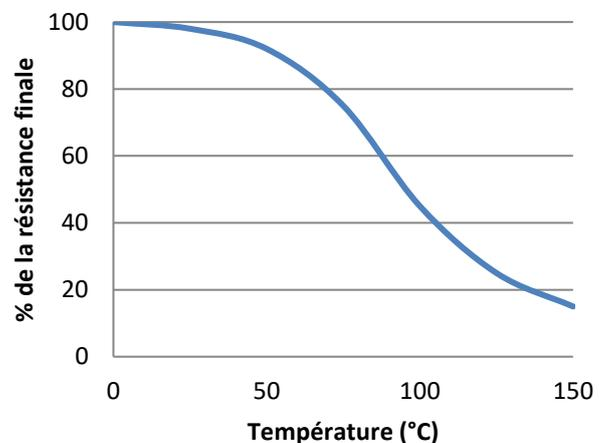
Essais de résistance au cisaillement à des températures élevées sur des assemblages de verre sur acier doux. Polymérisation complète à température ambiante, puis mise en température durant 30 minutes avant réalisation des essais.
