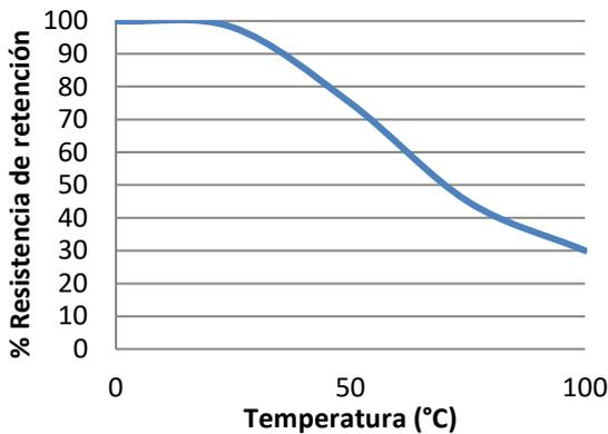
“Resistencia térmica” pruebas de resistencia realizadas en acero. Ejemplares completamente curados y condicionados a la temperatura de prueba durante 30 minutos antes de la prueba.
