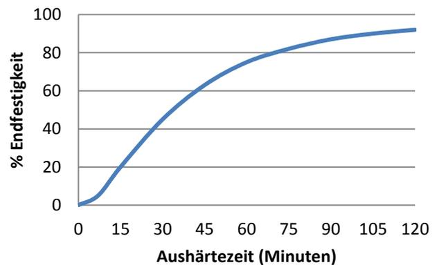
Das Diagramm zeigt den typischen Aufbau der Festigkeit bei der Verklebung von Probestücken bei 23°C. Aushärtung bei höheren oder niedrigeren Temperaturen beeinflusst die Aushärtungsgeschwindigkeit.
