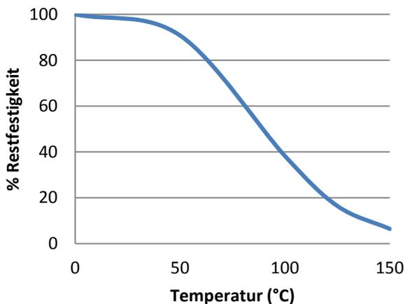
„Hitzebeständige“ Scherfestigkeitsversuche wurden auf Weichstahl durchgeführt. Aushärtung bei Raumtemperatur vollständig. Vor den Testversuchen wurden die Teile über 30 Minuten auf der Testtemperatur gehalten.
