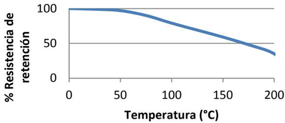
Resistencia térmica pruebas de resistencia realizadas en acero. Curado de 24 hr a temperatura ambiental y condicionado a la temperatura de prueba durante 30 minutos.
