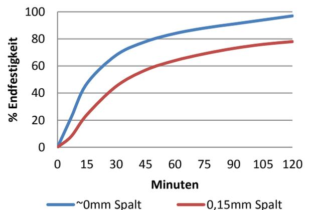
Das Diagramm zeigt den typischen Aufbau der Festigkeit bei der Verklebung von Probestücken bei 23°C. Aushärtung bei höheren oder niedrigeren Temperaturen beeinflusst die Aushärtungsgeschwindigkeit.
