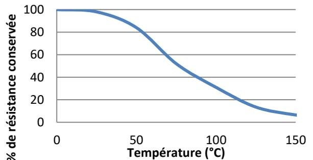
Essais de cisaillement en température réalisés sur de l'acier doux. Polymérisation complète à température ambiante, puis mise en température durant 30 minutes avant réalisation des essais.
