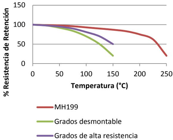
*"Resistencia Térmica" Resistencia a rotura en tuercas y tornillos zincados de M10 según la norma ISO 10964. Curado a 23°C durante 24 horas y después acondicionado durante 30 minutos a temperatura de prueba.*
