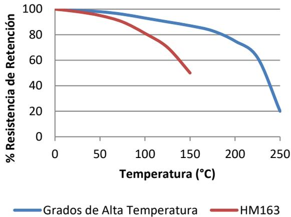
"Resistencia Térmica" Resistencia a rotura en tuercas y tornillos zincados de M10 según la norma ISO 10964. Curado a 23 °C durante 24 horas y después acondicionado durante 30 minutos a temperatura de prueba.
