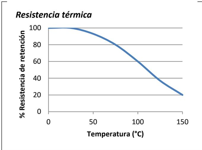
*“Resistencia térmica” Pruebas de resistencia realizadas en acero. Ejemplares completamente curados y condicionados a la temperatura de prueba durante 30 minutos antes de la prueba.*
