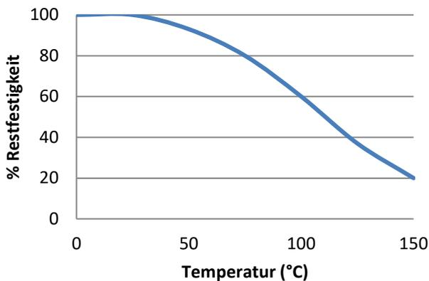
„Hitzebeständige“ Scherfestigkeitsversuche wurden auf Weichstahl durchgeführt. Aushärtung bei Raumtemperatur vollständig. Vor den Testversuchen wurden die Teile über 30 Minuten auf der Testtemperatur gehalten.
