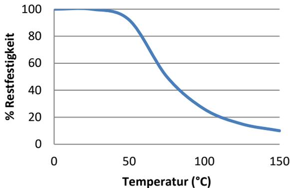
„Hitzebeständige“ Scherfestigkeitsversuche wurden auf Weichstahl durchgeführt. Aushärtung bei Raumtemperatur vollständig. Vor den Testversuchen wurden die Teile über 30 Minuten auf der Testtemperatur gehalten.
