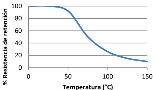
“Resistencia térmica” Pruebas de resistencia realizadas en acero. Ejemplares completamente curados y condicionados a la temperatura de prueba durante 30 minutos antes de la prueba.
