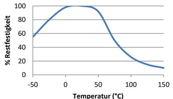
„Hitzebeständige“ Scherfestigkeitsversuche wurden auf Weichstahl durchgeführt. Aushärtung bei Raumtemperatur über 24 Stunden. Vor den Testversuchen wurden die Teile über 30 Minuten auf der Testtemperatur gehalten.
