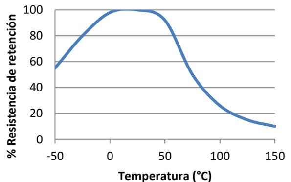
Resistencia térmica. pruebas de resistencia realizadas en acero. Curado de 24 hr a temperatura ambiental y condicionado a la temperatura de prueba durante 30 minutos.
