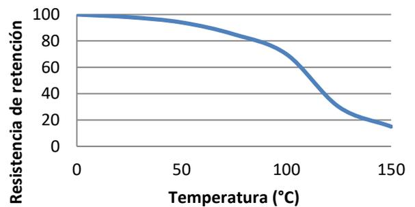
Resistencia térmica. pruebas de resistencia realizadas en acero e vidrio. Ejemplares completamente curados y condicionados a temperatura durante 30 minutos antes de la prueba a temperatura.
